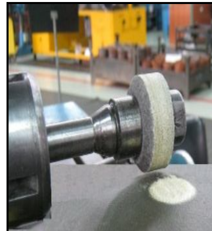
Şekil 3: Kompozit levhalardan talaş kaldırma işlemi
